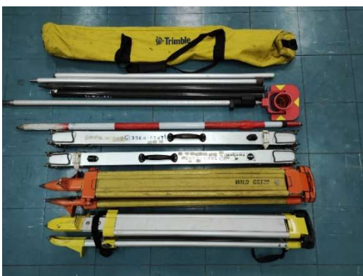
รูปที่ 7 อุปกรณ์การติดตั้ง วัดระยะ
