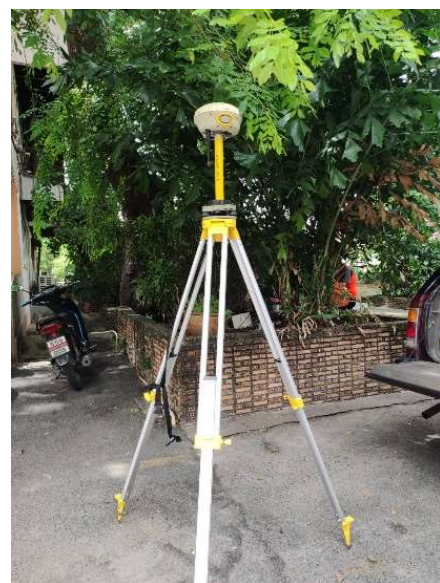
รูปที่ 9 ลักษณะการติดตั้งสถานีฐาน (Base Station)
