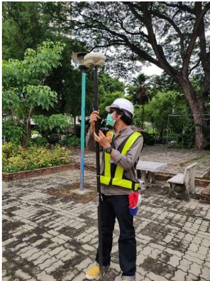
รูปที่ 10 ลักษณะการติดตั้งสถานีจร (Rover Station)
