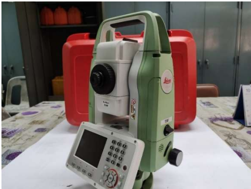
รูปที่ 5 เครื่องมือสำรวจรังวัดประมวลผลรวม
