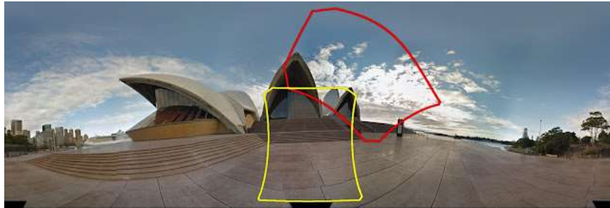
ภาพที่ 4: ขอบระหว่างภาพจากกล้อง Rosette Camera Rig ที่จะต้องนำมาเชื่อมต่อกัน
