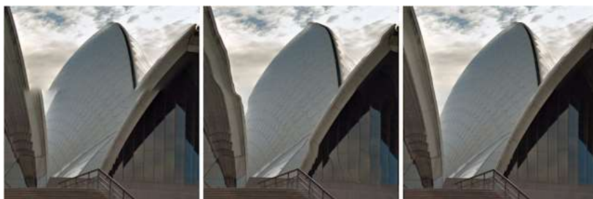
ภาพที่ 6: ภาพขยายของภาพถ่ายพาโนรามาที่ยังไม่ได้ปรับแก้/ภาพถ่ายพาโนรามาหลังจากที่ปรับแก้ด้วยการประมาณค่าแบบช่วง Kernel ซึ่งช่วยแก้ไขปัญหาภาพต่อกันไม่สนิทได้ แต่ก็ตามมาด้วยปัญหา Wobbling Artifacts เนื่องจากกรูปลูกถ่ายแต่ละภาพที่มาต่อกันมีขนาดเล็กและมีข้อจำกัดของ Footprint of Kernels/ ภาพถ่ายที่ได้จากการทำ Global Optimization ตามลำดับ
