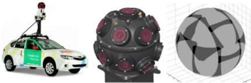
ภาพที่ 2: รถ Street View ที่ใช้กล้อง Multi-Camera Rosette/ภาพระยะใกล้ของ Rosette ซึ่งมีกล้องติดอยู่โดยรอบ 15 ตัว/ภาพจำลองเชิงพื้นที่ผิวโดยรวมของกล้องแต่ละตัว ซึ่งมีการแสดงรายละเอียดของขอบที่ติดกันระหว่างกล้องแต่ละตัวซึ่งแสดงในเฉดสีเทาเข้ม ตามลำดับ
